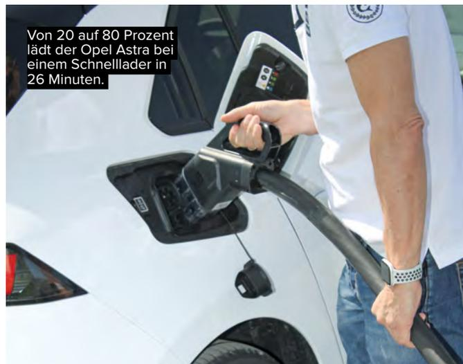
Von 20 auf 80 Prozent lädt der Opel Astra bei einem Schnelllader in 26 Minuten.
