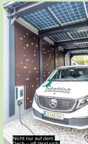
Nicht nur auf dem Dach – oft lässt sich eine PV-Anlage auch auf innovative Art und Weise in die bestehende Bausubstanz integrieren, wie hier auf dem Carport.
