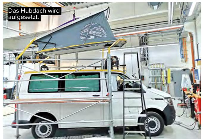
Das Hubdach wird aufgesetzt.
